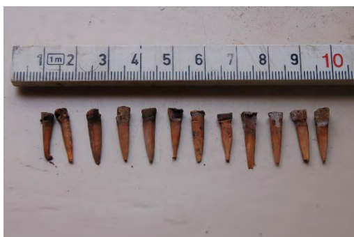
Afb. 3d - houten spies uit het spanraam
